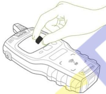
Coloque el transpondedor en la posición de la bobina para detectar la imagen mostrada.
